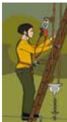
Das C-CONNECT V2-Element nicht direkt am Seil einer Seilrutsche befestigen
