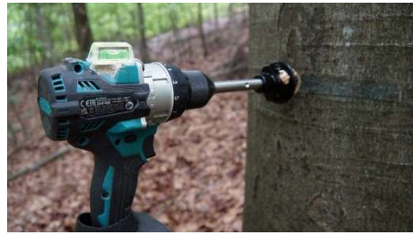
2.3.2 Loch, bis zur gewünschten Tiefe Bohren.
