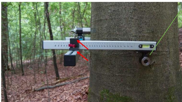
**Klemmschrauben** lösen und den ersten Arm auf die gewünschte Position schieben.
