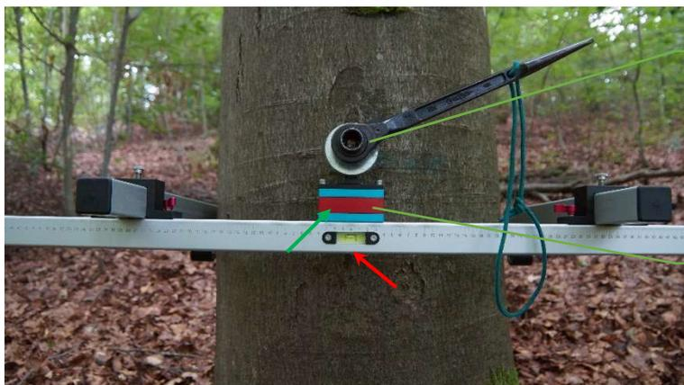
Anbringen der Bohrvorrichtung. Anhand der **Wasserwaage** ausrichten und mit Mutter und Unterlagscheibe festziehen.
