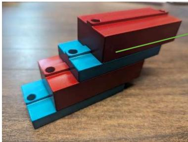
Je nach Dicke der Unterkonstruktionshölzer kann es notwendig sein das Achsmaß der Vorrichtung anzupassen.
