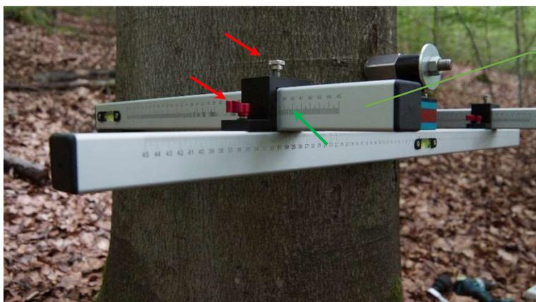
**Klemmschrauben** lösen und den zweiten Arm, unter Zuhilfenahme der **Skalierung** auf die abgelesene Position schieben.
