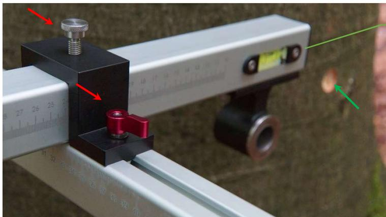
**Klemmschrauben** lösen und die Arme aus dem **Arbeitsbereich** entfernen.
