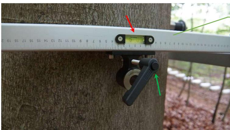
Seitenarme anhand der **Wasserwaagen** ausrichten und mit der **Zentriereinheiten** am Stamm fixieren.
