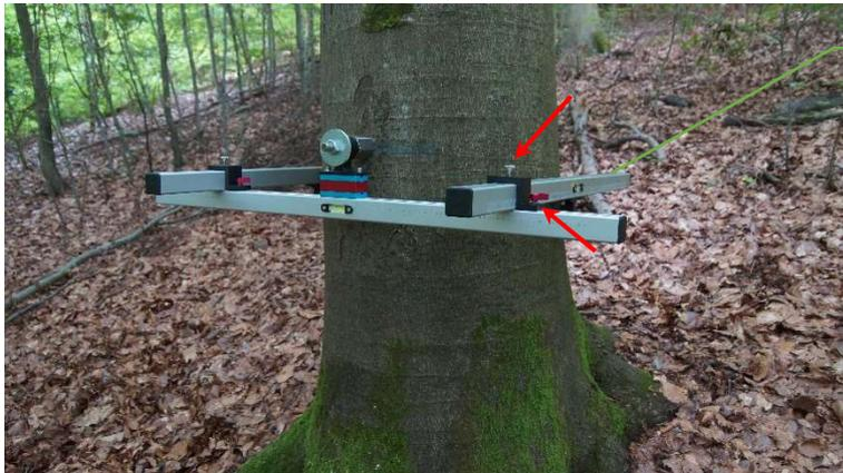
**Klemmschrauben** lösen und den ersten Arm auf die gewünschte Position schieben.
