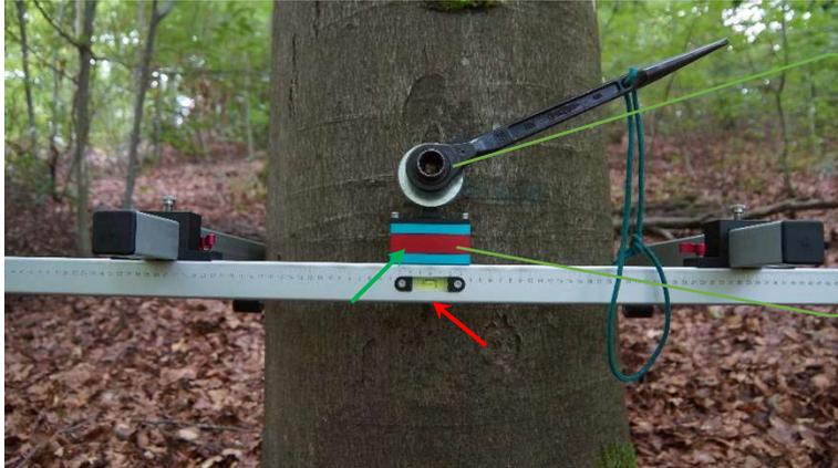
Anbringen der Bohrvorrichtung. Anhand der **Wasserwaage** ausrichten und mit Mutter und Unterlagscheibe festziehen.
