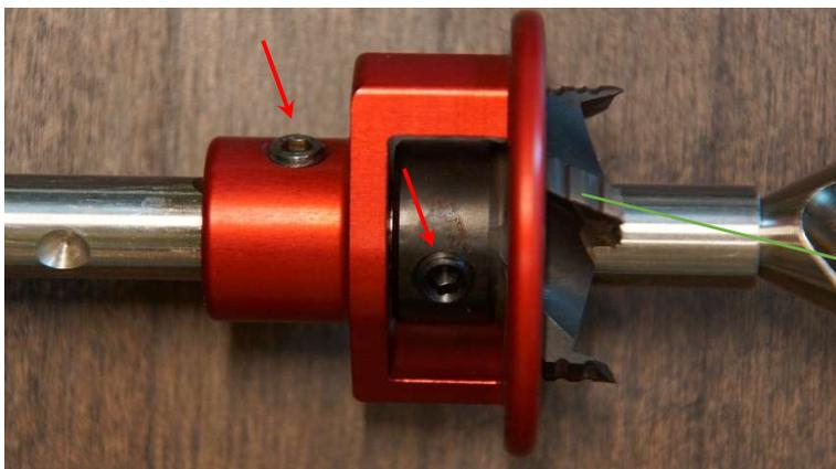
Die Position des Senkers und des Tiefenanschlages, in Abhängigkeit des Schraubentyps, festlegen.
