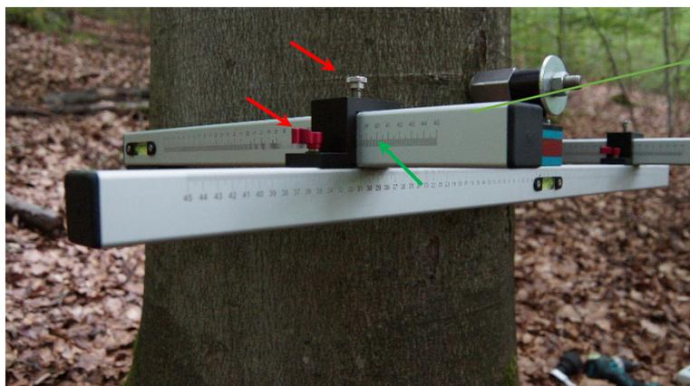
Desserrer les **vis de serrage** et déplacer le deuxième bras dans la position souhaitée à l'aide de la **graduation**.
