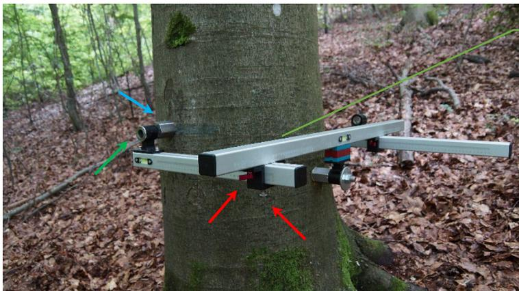
Desserrer les **vis de serrage** et alignez le **manchon de perçage** avec le **BABO BOLT**.
