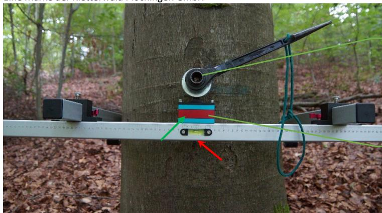
Fixez le dispositif de perçage. Utiliser le **niveau à bulle** pour aligner et serrer avec l'écrou et la rondelle.
