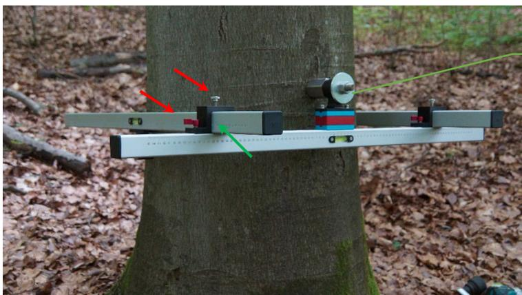
Desserrer les **vis de serrage** et déplacer le deuxième bras dans la position souhaitée à l'aide de la **graduation**.
