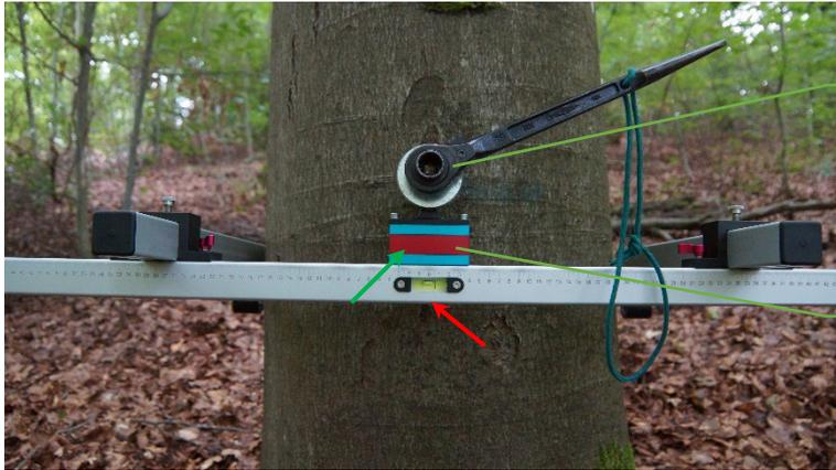
Fixez le dispositif de perçage.
