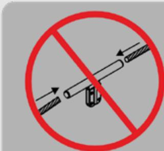
Il est interdit d'installer ce composant en tant que connecteur de câble
