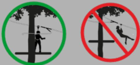
Le sertissage du câble ne peut se faire qu'entre deux ancrages et sur une plate-forme. Il ne doit jamais être fait sur un élément de parcours.
