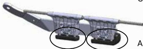
Schutz der Ankerschrauben bei der Ankunft der Seilbahn
