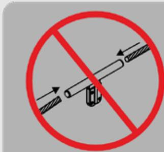
Es ist verboten dieses Bauteil als Kabelverbinder zu installieren
