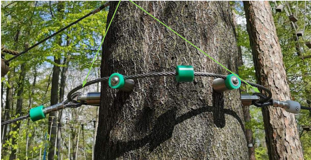
Asegurarse de que el cable no dañe la corteza del árbol, por ejemplo por fricción. Si es necesario, se debe instalar un dispositivo antiabrasión (ver también 2.6).
