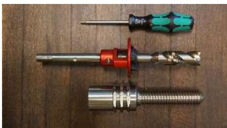
2.3.1 Ajustar la herramienta de perforación según el tornillo.
