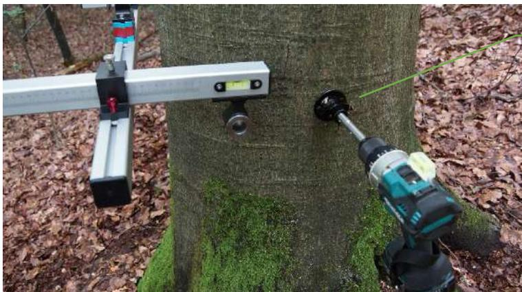
Instalar el segundo BABO BOLT según las instrucciones de instalación.
