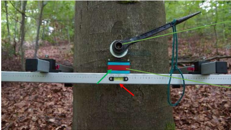
Asegurar la plantilla de montaje utilizando el **nivel de burbuja** para alinear y apretar con la tuerca y la arandela.
