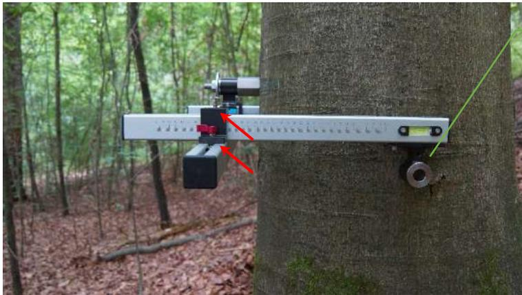
Aflojar los **tornillos de sujeción** y mover el primer brazo hasta llegar a la posición deseada.
