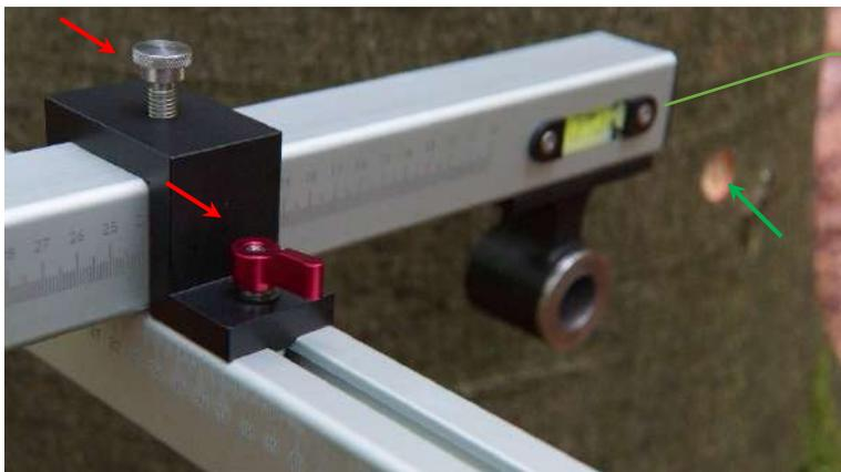
Aflojar los **tornillos de sujeción** retirar los brazos del **área de trabajo**.
