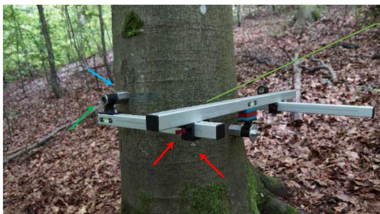
Aflojar los **tornillos de sujeción** alinear la **guía de la broca** con el **BABO BOLT**.
