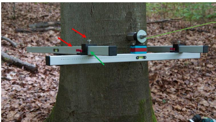
Aflojar los **tornillos de sujeción** mover el segundo brazo hasta llegar a la posición deseada usando la escala de **graduación**. Apretar los **tornillos de sujeción**.
