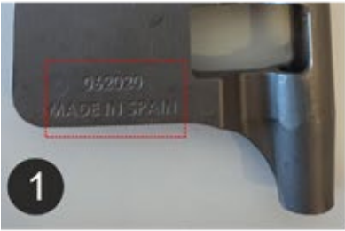
1 Vérification de la lisibilité du numéro de série du DCM et de l'ancrage
