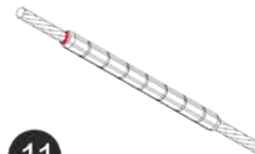
11 Vérification du déplacement des câbles aux jonctions avec les connecteurs de câble
