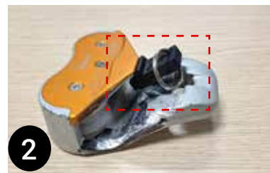
2 Vérification de l'usure du DCM (Espace libre entre le verrou et le foncet 7,5 < x < 9,3 mm). Si le gabarit de contrôle passe dans la poulie, la mettre au rebut.
