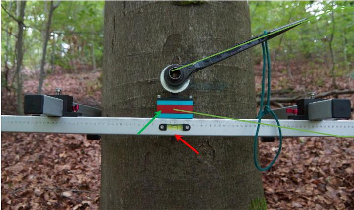
Anbringen der Bohrvorrichtung. Anhand der **Wasserwaage** ausrichten und mit Mutter und Unterlagscheibe festziehen.
