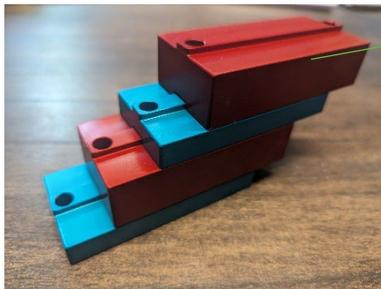
Je nach Stärke der Holzunterkonstruktion kann es notwendig sein, die axiale Abmessung der Vorrichtung anzupassen, indem Sie farbige **Abstandsplatten** hinzufügen, um im Achsabstand in die Unterkonstruktionen (Bohlen, Rundhölzer ...) zu bohren.
