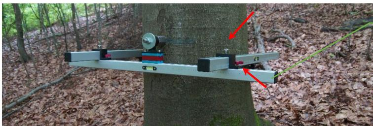
**Klemmschrauben** lösen und den ersten Arm auf die gewünschte Position schieben.
