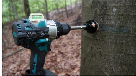
2.3.2 Bohren Sie das Loch **mit einer Bohrkapsel** bis zur gewünschten Tiefe (**max. 10 mm**) in das **Splintholz**.
