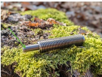
2.6.5 In Nadelholz ist wahlweise der Einbau mit RAMPA Muffe typ SKL, Stahl rostfrei 1.4305, D 18,5, d M10, L 80mm zu Empfehlen. ETA-12/048 1
