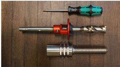
2.3.1 Multibohrwerkzeug auf Schraube einstellen.
