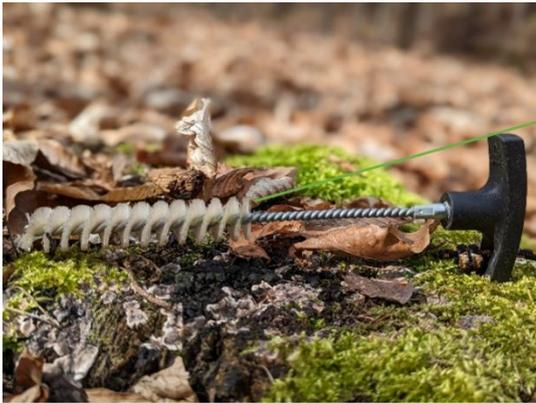
Lochbürste Ø passend zur Bohrung. Wird verwendet um das Bohrloch von Holzspänen zu befreien. **ACHTUNG** vor Gebrauch desinfizieren!
