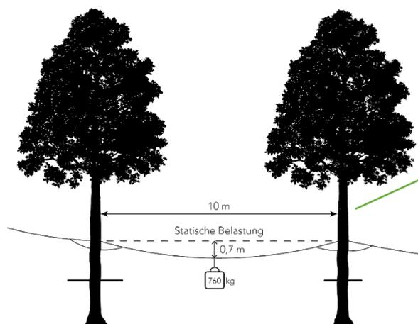
Beispielhafte Berechnung des benötigten Seildurchhangs für Nadelholz, anhand der „Siebert Formel“ unter Berücksichtigung der EN15567.
