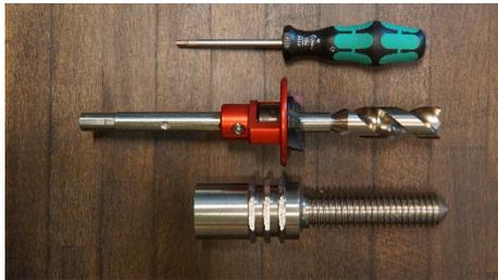
2.3.1 Stellen Sie den Fräser und den Anschlag am Bohrwerkzeug entsprechend dem zu installierenden BABO BOLT (Laub- oder Nadelholz) ein.
