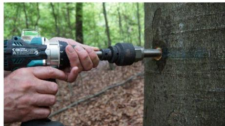
2.3.6 Positionieren Sie den BABO BOLT mithilfe eines Akkuschaubers oder Schraubers (max. Drehmoment 1000Nm) waagrecht.
