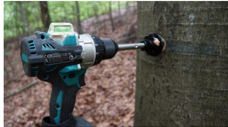
2.3.2 Bohren Sie das Loch bis zur gewünschten Tiefe mit einer maximalen Kapelle von 10 mm in das Kambium des Baumes.
