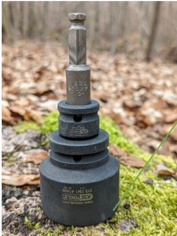
Nuss SW 41 mit Reduzierung und Adapter zur Montage der Baumbolzen.
