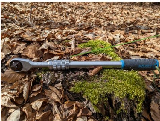
Teleskop Ratsche wird verwendet um die mit dem Akkuschauber, im 1. Gang (kein Schlagschauber), vorangezogenen Bolzen bis zur gewünschten Position einzudrehen.
