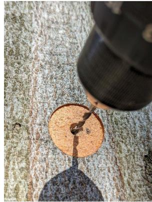
2.6.2 Mit 4mm Bohrer 4cm tief vorbohren.
