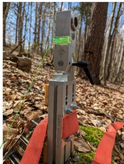
Wasserwaage zur Herstellung einer waagerechten Bohrung.
