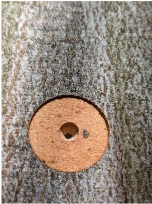
2.6.1 Stellen Sie mit dem Fräsbohrer mit einem Durchmesser von 40 mm eine ebene Fläche her.
