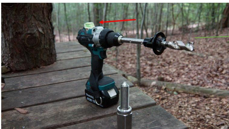
Die Herstellung einer Stufenbohrung erfolgt nun, unter Beachtung der Einbauanleitung für Plattformbolzen (« Rev A // 06-06-2024 ») unter Zuhilfenahme eines Akkuschraubers mit Wasserwaage oder einer Bohrvorrichtung.
