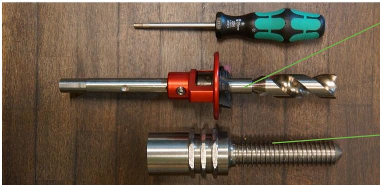
WICHTIG: vor dem festziehen der zwei Inbusschrauben die Fläche des Bohrerschaftes (6-Kant) rechtwinklig zu den zwei Inbusschrauben ausrichten
